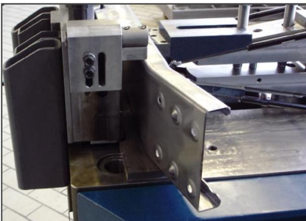
Abkanten von Rahmenteilen für LKW-Fertigung
